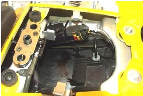
Der Förderschlauch kann entlang der Schwinge verlegt werden unter Benutzung der Omegahalter und Klebers. Die Spendereinheit mit der kleinen Spenderplatte und Schlauchschelle (Teile 20 & 21) an der Prismenaufnahme befestigen. Weitere Informationen, siehe - [Anleitung Spenderplatte](#). Die Düse soll zwischen 6 und 7 Uhr auf das Kettenrad zeigen, die abgeschnittene Seite nach außen.
