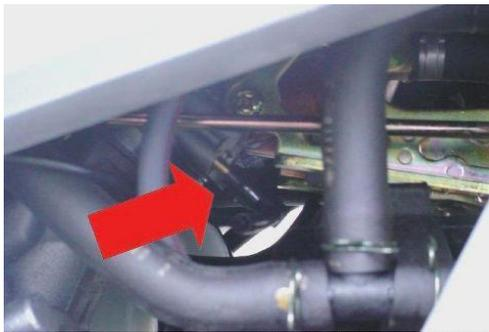
Das RMV kann unter dem Sitz oder hinter dem Nummernschild montiert werden. Je vertikaler das RMV montiert wird desto besser. Vermeiden Sie die Nähe des Auspuffs und des Motors. Für weitere Informationen, sehen Sie in die "Easy step Installationen" - [RMV Positionen generell](#).
